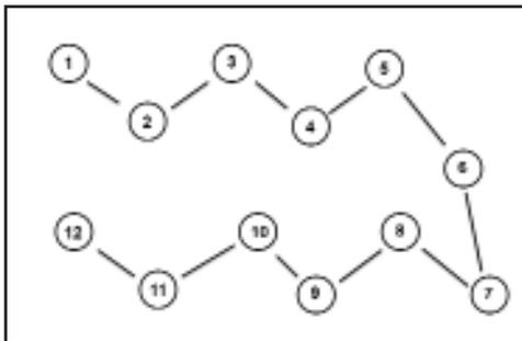
**Figure 5.** Méthode suggérée pour l'échantillonnage de sol (adapté de Rosen et al. 2004<sup>26</sup>)
