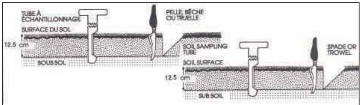
**Figure 6.** Méthode d'échantillonnage de sol (Tiré de Rosen et al., 2004<sup>26</sup>)
