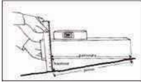
**Figure 1.** Mesurer une pente à l'aide de la technique de barre de mise à niveau (Tiré de [http://www.cmhc-schl.gc.ca/fr/co/enlo/ampa/ampa\\_005.cfm](http://www.cmhc-schl.gc.ca/fr/co/enlo/ampa/ampa_005.cfm))
