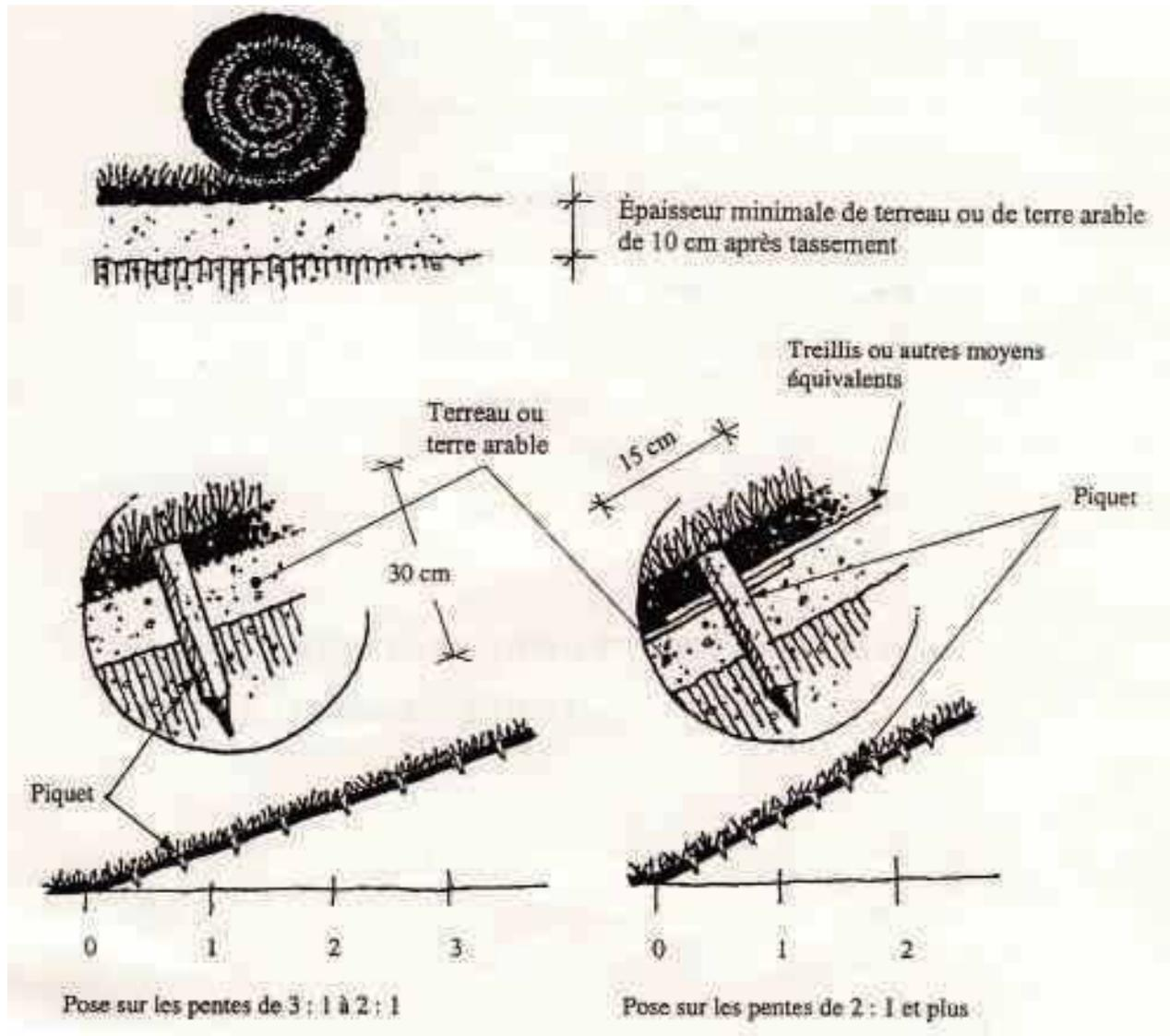
Figure 16. Pose du gazon en plaques (Tiré de BNQ, 2001a<sup>5</sup>)
